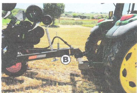
di telaio robusto con timone anteriore di III cat. per l'accoppiamento al trattore, con chiusura dei due moduli laterali per il rientro in sagoma a 2,4 m durante il trasporto su strada e una coppia di ruote posteriori con funzione di appoggio in lavoro e durante il trasporto su strada.
