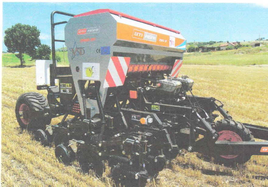
La **seminatrice da sodo** di tipo semi-portato vista in prova è equipaggiata con **assolcatori a doppio disco**, su cui il costruttore argentino ha apportato delle **modifiche molto attente alle condizioni di campo**
